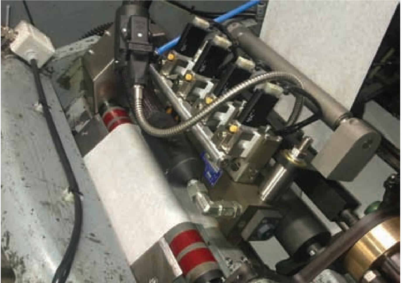
Unsere Lösung beinhaltet die Schwenkhalterung mit Seitenverstellung, eine Vakuumwalze mit Bremse und Kupplung, eine Vorzugswalze, eine Luftplatte, einen auf das Maschinenmodell abgestimmten Auftragskopf mit Negativ-Ventilen und optimierter Düsenleisten-Geometrie. Dazu kommt eine Auftragssteuerung und eine Maschinenanbindung, die wir mittels einer Siemens-Steuerung realisieren.
